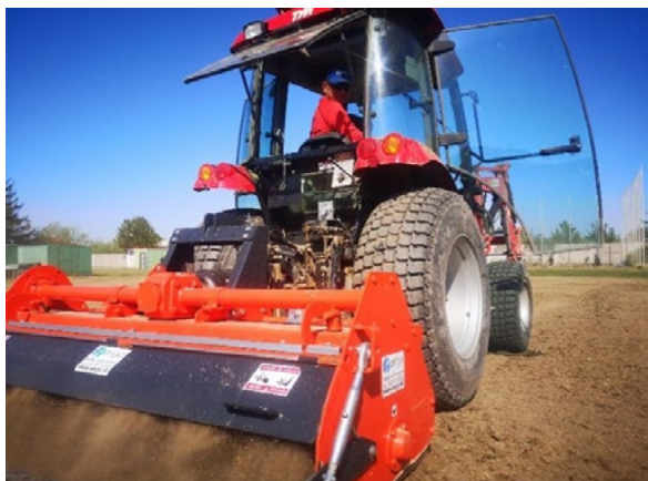
Nakyprenie povrchu do hĺbky 8-10 cm
