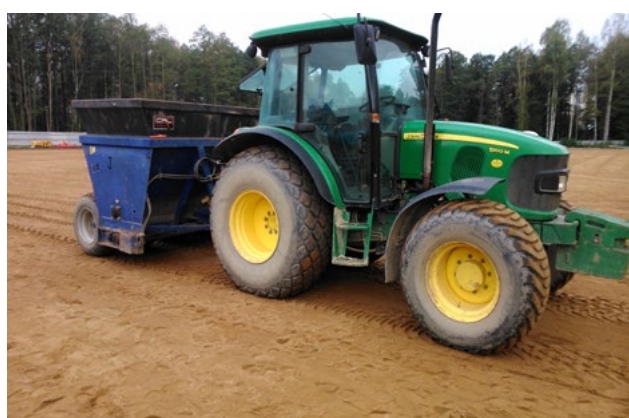
Namiešaná zmes sa nanáša na spodnú koreňovú zónu a tvorí tzv. hornú koreňovú zónu.
