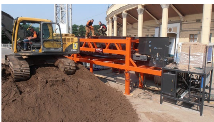
Miešanie piesku s umelým vláknom a rašelinou v špeciálnom zariadení.
